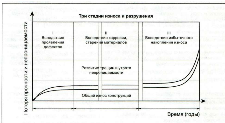
Рис. 10.5. Пример накопления износа бетоном
